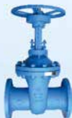
Keilrundschieber DIN3352 - PN10-100 außenl. Spindel - metallisch dichtend Material: GP240GH+N / P250GH / 1.4408 Fig.030-033, 034, 036, 037, 066, 067, 074-076
