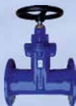
Keilovalschieber - PN10/16/25 innenl. Spindel - weichdichtend EPDM/NBR Material: GJS-500-7 - EKB-beschichtet Fig.802, 803, 805
